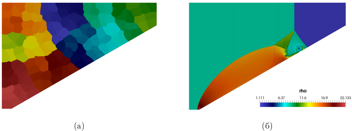
Рис. 2. Моделирование двойного Маховского отражения: (а) – разбиение расчетной области на подобласти; (б) – распределение плотности в момент времени T = 0.2
