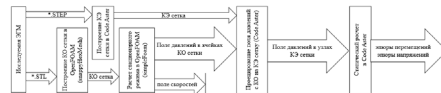
Рис. 1. Алгоритм расчета при квазистатической постановке задачи Fig. 1. Simulation algorithm at quasistatic problem definition
