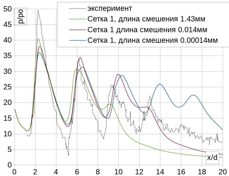
Рис. 6. Сравнение расчётного поля приведённого полного давления, полученного при задании различной длины смещения на входе расчётной области, т.е. турбулентной вязкости
