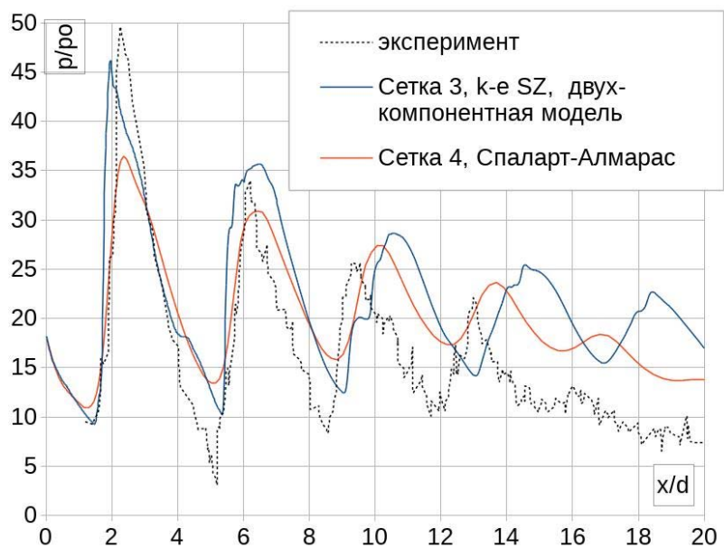
Рис. 7. Сравнение расчётного поля приведённого полного давления, полученного при использовании различных моделей турбулентности
