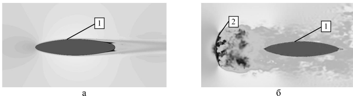
Рис. 3. Мгновенная структура обтекания килевого стабилизатора (1): а – без щитка ( \beta = 0^\circ ); б – с тормозным щитком (2) ( \beta = 60^\circ )
