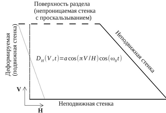
Рисунок 2. Принципиальная схема расчётной области и физических внешних границ
